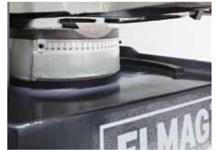
Gut ablesbare Winkelskala \pm 45^\circ für präzise Einstellung des Schnittwinkels
