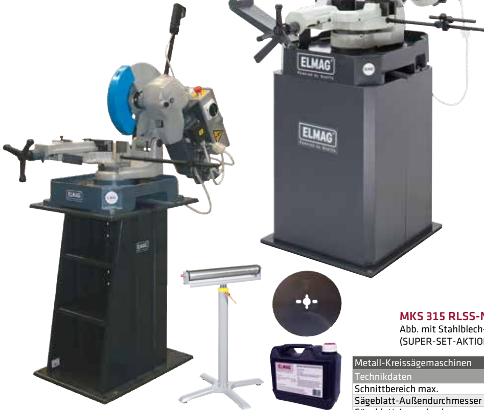
Gut ablesbare Winkelskala \pm 45^\circ für präzise Einstellung des Schnittwinkels
