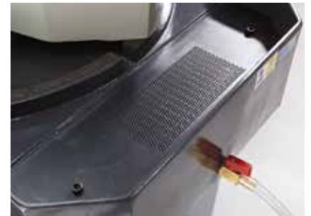
Spänewanne mit Kühlmittelbehälter, Abb. Rücklaufilter und Dosierventil
