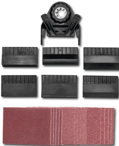
22-teiliges Set zum Schleifen in Nuten und an Außenradien. Inhalt: 1 Halter mit 6 unterschiedliche Profil-Einsätzen. 1× V-Form für 90°-Winkel, 1× Trapezform für Nut- und Feder-Verbindungen, 1× gerade Form für Profile, 1× konvexe Form (groß), je 1× konkave und konvexe Form (klein) sowie je 5 Schleifblätter Korn 80, 120 und 180.
