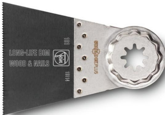
Bi-Metall mit geschränkter Holzverzahnung für alle Holz-, Gipskarton- und Kunststoffmaterialien. Hervorragende Standzeit, hohe Schnittqualität und guter Arbeitsfortschritt. Äußerst robust, unempfindlich auch gegen im Holz befindliche Nägel (bis ca. Ø 4 mm), Mauerwerk etc. Breite Form für maximale Schneidleistung und lange gerade Schnitte.
