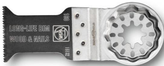
Bi-Metall mit geschränkter Holzverzahnung für alle Holz-, Gipskarton- und Kunststoffmaterialien. Hervorragende Standzeit, hohe Schnittqualität und guter Arbeitsfortschritt. Äußerst robust, unempfindlich auch gegen im Holz befindliche Nägel (bis ca. Ø 4 mm), Mauerwerk etc. Mittlere Breite, taillierte Form für optimale Schnittgeschwindigkeit und gute Spanabfuhr.
