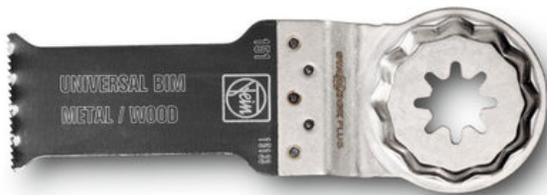
Bi-Metall mit gewellter Universalverzahnung. Breites Anwendungsspektrum für Blech bis 2 mm, Alu-Profile, Cu-Rohre, Holz, Gipskarton und Kunststoffe. Schmale, taillierte Form für optimale Schnittgeschwindigkeit und gute Spanabfuhr.
