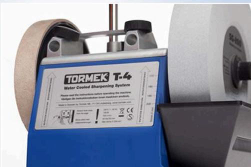
Das Maschinschild ist jetzt aus Metall, der Platz um den Tormek AngleMaster mit seinen magnetischen Füßen zu befestigen.
