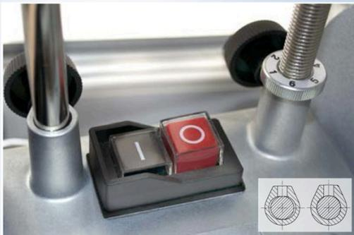
Die Hülsen für die Universalstütze sind jetzt im gegossenen Zinkoberteil integriert. Zusammen mit der neuen Tormek stadienförmigen Konstruktion der Löcher (zum Patent angemeldet) wurden die Präzision über 300% verbessert werden.
