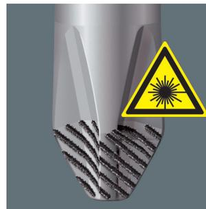
Mittels eng fokussiertem Laserlicht wird eine scharfkantige Oberflächenstruktur erzeugt. Die Laserbehandlung bewirkt eine Härte der Spuren von bis zu 1000 HV 0,3. Wera Lasertip krallt sich im Schraubenschaft fest und verhindert das Herausrutschen aus dem Schraubenschaft. Bei Schlitz, Phillips und Pozidriv.
